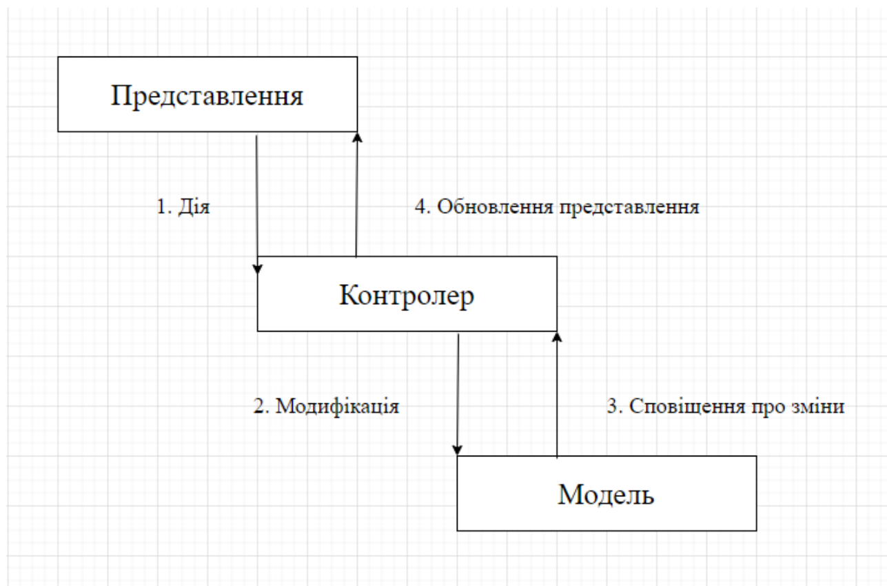
Рисунок 2.1 - Схема архітектури «Модель-Вид-Контролер»
